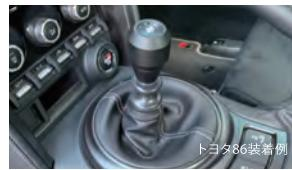
適合車種 リバースロックレバーがノブに入り込むタイプの6速MT車
